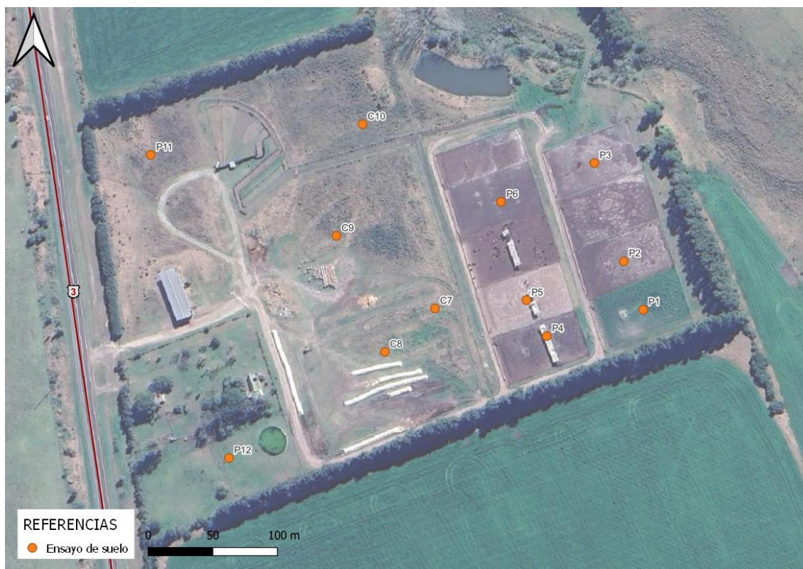
Figura 6-2: Puntos de calicatas y toma de muestras, estudio geotécnico LINSU.
