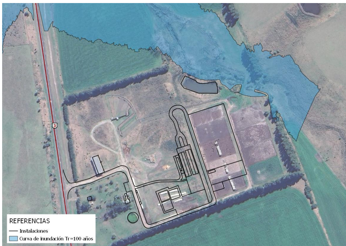
Figura 6-8: Inundación del predio para una crecida de TR=100 años. Fuente: elaboración propia a partir de la información SIG generada durante el Estudio de Inundabilidad, CSI Ingenieros.
